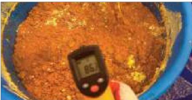
20. De temperatuur nadert de 90 \ddot{y} (194 \ddot{y} ), smelten is dat wel versneld. Er gingen 5 minuten voorbij.
