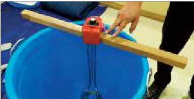
Gebruik een verwarming van 3 kW voor 500 liter (132 gal), 1,5 kW voor 100-300 liter (26-79 gal).
