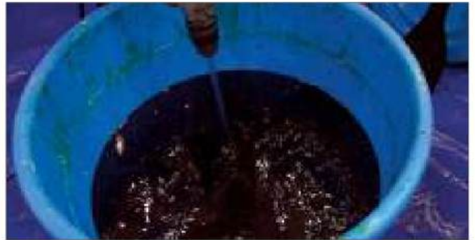
29. Na 24 uur kunt u een elektrische boormachine gebruiken om te mixen. Niet doen gebruik de machine vóór die fase omdat dit gevaarlijk is.
