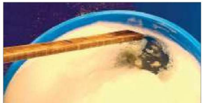
24. Voeg 60 liter water toe; gebruik een schone houten stok grondig met de hand roeren.
