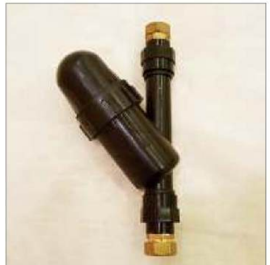
Filter voor vloeibare meststoffen. De vloeistof gaat voorbij door een stalen filter van 100 mesh. Dit voorkomt dat de slangen verstopt raken. Open de ronde dop en maak deze regelmatig schoon.
