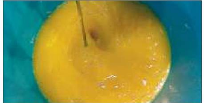
13. De kleur blijft veranderen en de viscositeit neemt toe. Er gingen 3 minuten voorbij.
