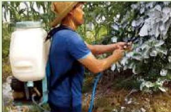
Hier hebben we het mondstuk van een motorsproeier vervangen door een schuimpistoolmondstuk. (Demonstratie door Hyunho Cha)
