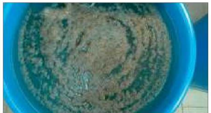
14. De schuimschijf begint af te brokkelen; wat aangeeft dat de microben beginnen te sterven. (84 uur)
