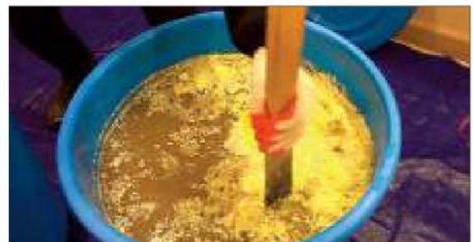
16. Roer grondig om alle zwavel onderaan te laten smelten.
