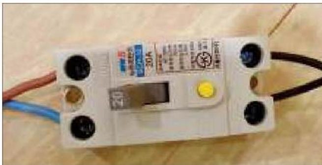
Gebruik voor de veiligheid een ELCB (aardlekschakelaar); langdurig gebruik kan oververhitting veroorzaken
