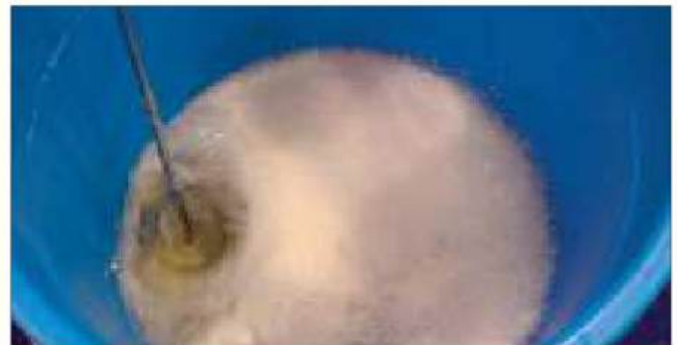
22. Gebruik een elektrische boormachine om alles grondig te mengen, inclusief de onderkant, om alles wat aan de muren vastzit te verwijderen.
