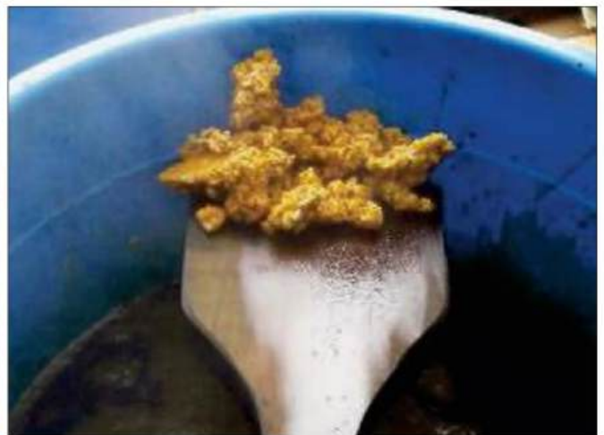
Als het aanvankelijke water te klein is, zal de intense hitte stollen zwavel. Eenmaal gestold, zal het niet smelten.
