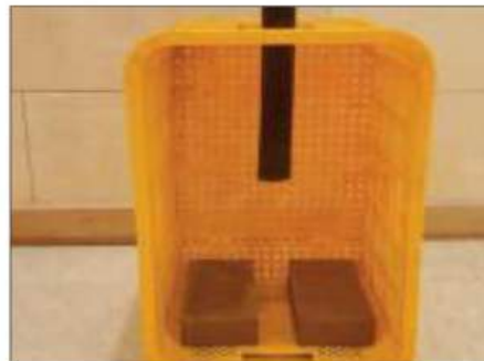
2. Plaats een pijp zo dat de opening zich in het midden bevindt van de doos. De leiding wordt aangesloten op een elektrische motor
