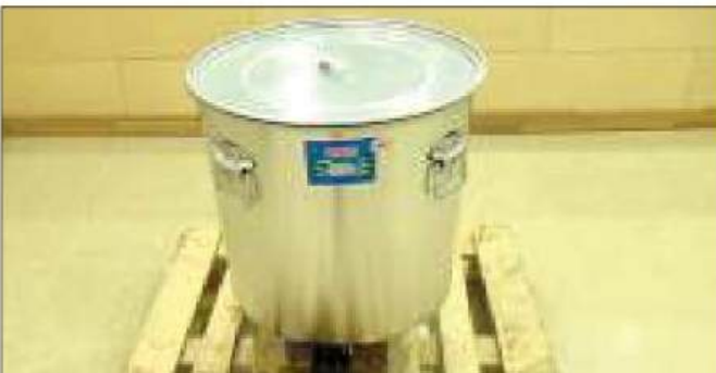
3. Zet een container van 100 liter (26,4 gal) en de gasbrander klaar. Werk in een goed geventileerde ruimte.
