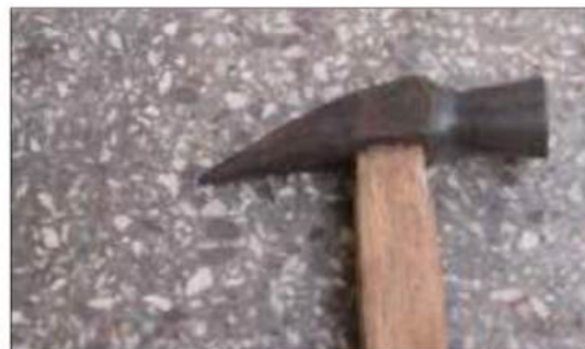
2. Gebruik de scherpe punt van een hamer om gaten te slaan
