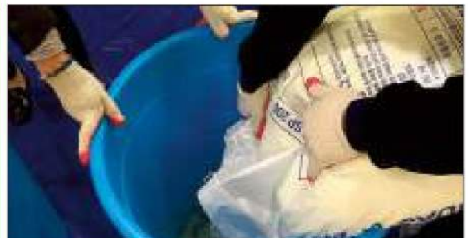
7. Voeg 25 kg (55,1 lb) zwavel toe. Doe het langzaam, zodat er geen stof ontstaat zal niet stijgen.
