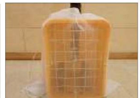
6. Sluit de opening van de zak stevig af. Doe het in 5 t (1.320 gal) container en sluit de motor aan.
