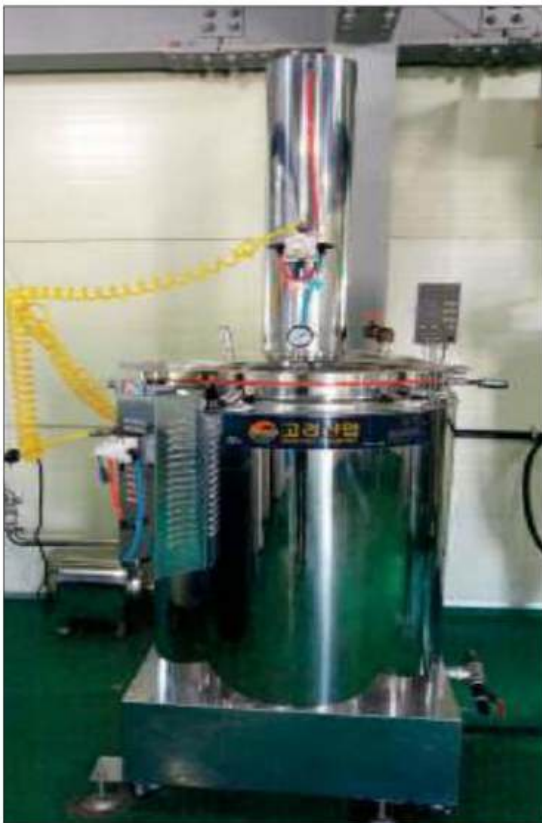
Massaproductie van kruidenoplossing met behulp van grote hogedrukpot. Foto: Gyeongho Yun
