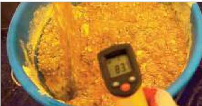
19. Wanneer de temperatuur hoger is dan 80 \ddot{y} (176 \ddot{y} ), zwavel begint te smelten. Er gingen 4 minuten voorbij.
