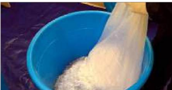
12. Voeg 20 kg bijtende soda toe. Doe het langzaam zodat er geen stof ontstaat.
